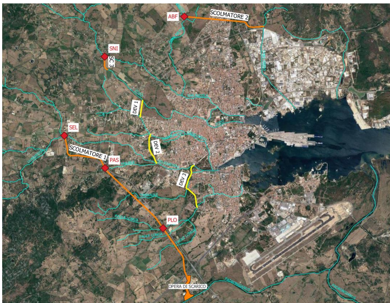
Figura 2.1: Rappresentazione della soluzione progettuale. In arancione, i tracciati dei tre scolmatori: scolmatore 1 Seligheddu-Padrongianus con l'opera di scarico nel Padrongianus, scolmatore 2 Abba Fritta-Cabu Abbas e scolmatore 3 San Nicola-Zozò. In rosso, le opere di presa degli scolmatori: ABF – Abba Fritta; SNI – San Nicola; SEL – Seligheddu; PAS – Pasana; PLO – Paole Longa. In giallo, i deviatori in città: DEV1 - Zozò-Gadduresu; DEV2 - Gadduresu-Seligheddu; DEV3 - Paole Longa/Tannaule-Seligheddu.
